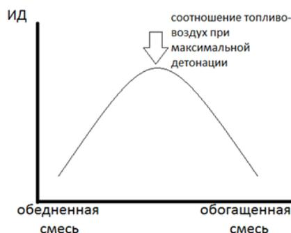
Рис. 6.3 Распределение интенсивности детонации в зависимости от соотношения компонентов смеси
