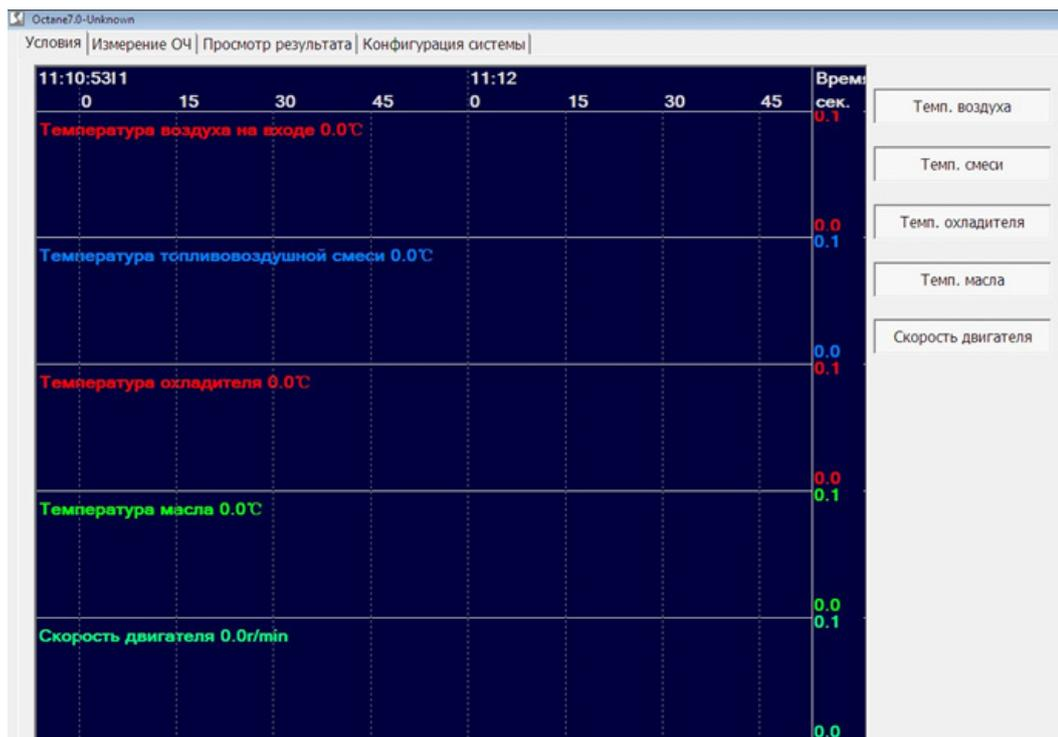
На данной вкладке отображаются условия работы двигателя в реальном времени, включая мощность двигателя, температуру подаваемого воздуха, температуру рабочей смеси, температуру охлаждающей воды и температуру масла.
