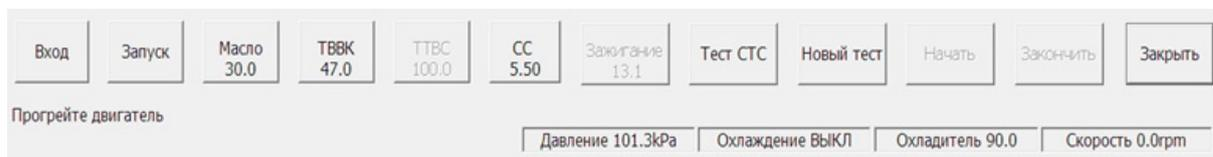
5.1.1 «Вход». Перед запуском анализатора требуется произвести вход в систему под соответствующим уровнем доступа к функциям (пароль по умолчанию «123456»):
