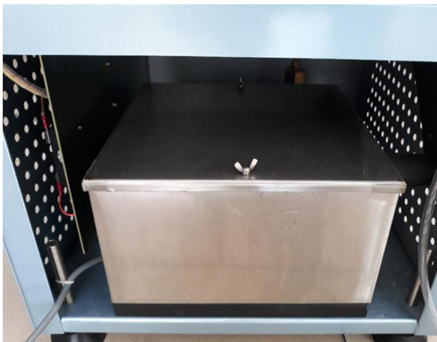
Рис. 3.2.5 Резервуар колонки осушки воздуха
