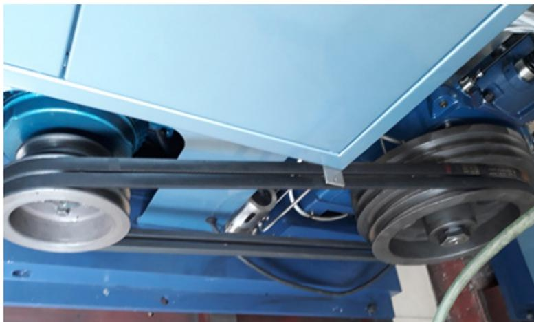
Рис. 6.5.2.1 Установка ремней на моторный метод
