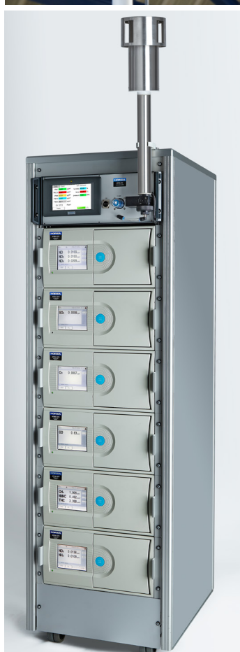
Приборная стойка с газоанализаторами HORIBA AP-370
