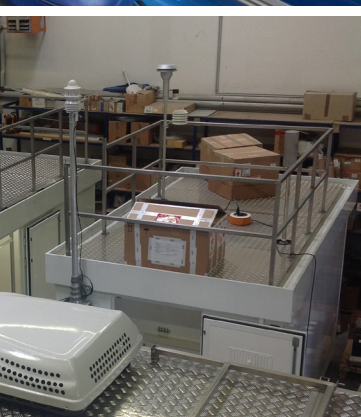
Производство и сборка экологических лабораторий, подготовка к монтажу на автомобильную платформу
